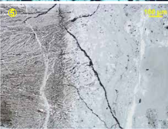
第 179 図 鑄造鉄器片のEPMA調査・顕微鏡組織
