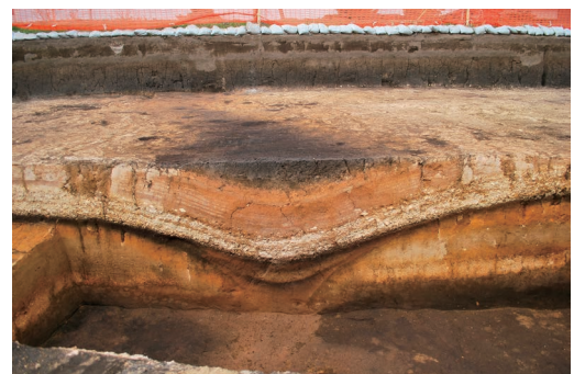
写真4 池田軽石層（Ⅴb層）の下に水性堆積物が看取され、池田軽石降下以前に陥没したことを示す。
