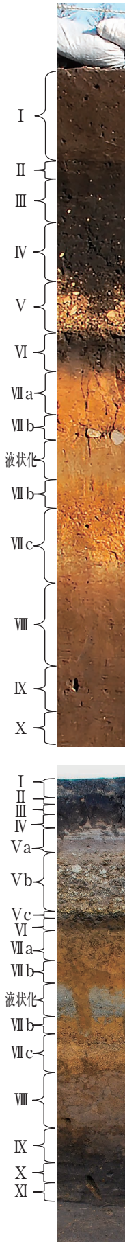
写真1 土層断面上の液状化の層状堆積とⅧ層（縄文時代早期包含層）上面の噴砂脈
