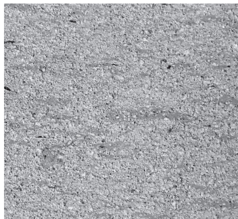
図19 石造物にみるユータキシティック構造
