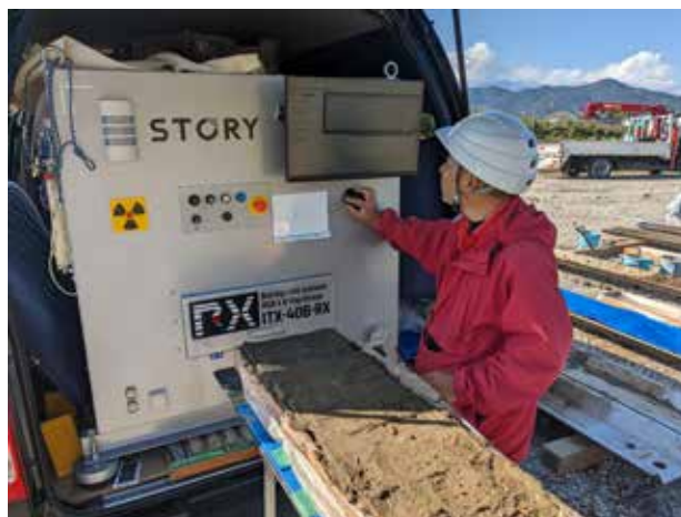
図4 地層抜き取り試料の4K画像・X線画像撮影作業 （2023年・南大原遺跡）
