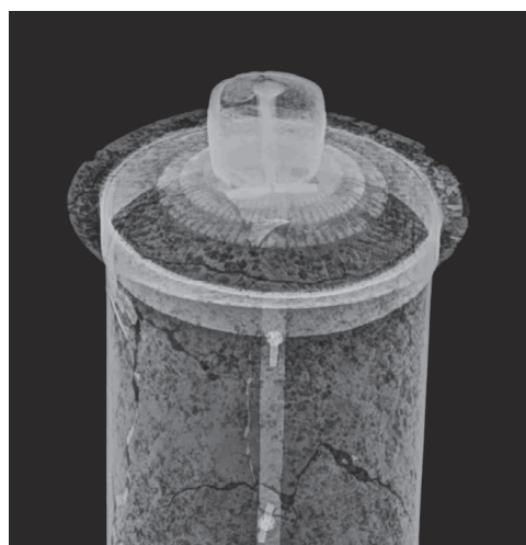
4. 蓋各部件の組み合わせ状況 (X線透過写真)
