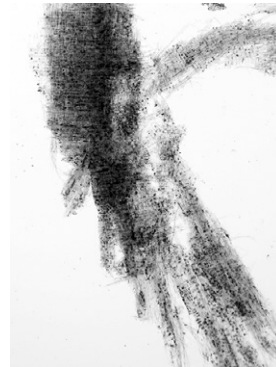
2.スギ(木筒19)左:柾目80x、右:同左部分拡大320x
