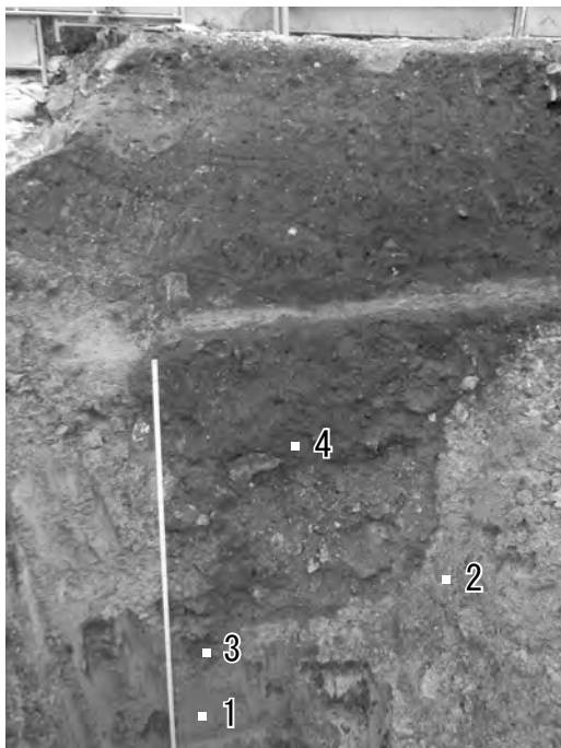
図 120 地点 1(14区)における深掘の地層断面 東から撮影、白丸は試料採取層準、数字は試料番号を示す
