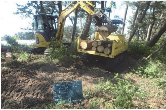
写真 32 グラップルによる積み込み
