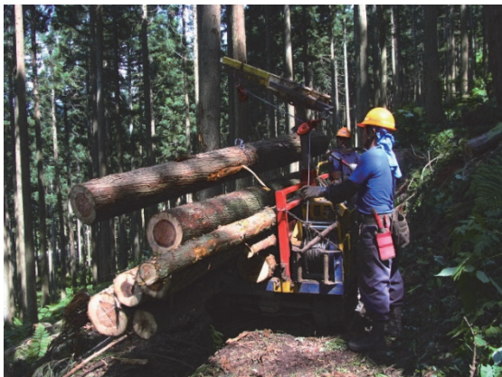
写真 34 ウインチ付き林内作業車による運搬
