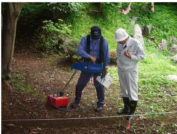
地中レーダー探査状況
