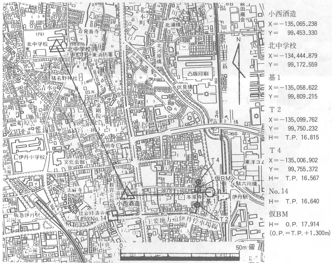
第5図 国土座標基準点・水準点網図
