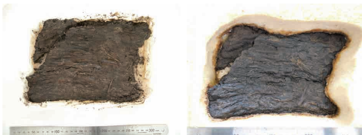
第 187 図 実験 3 PEG 含浸法処理工程
