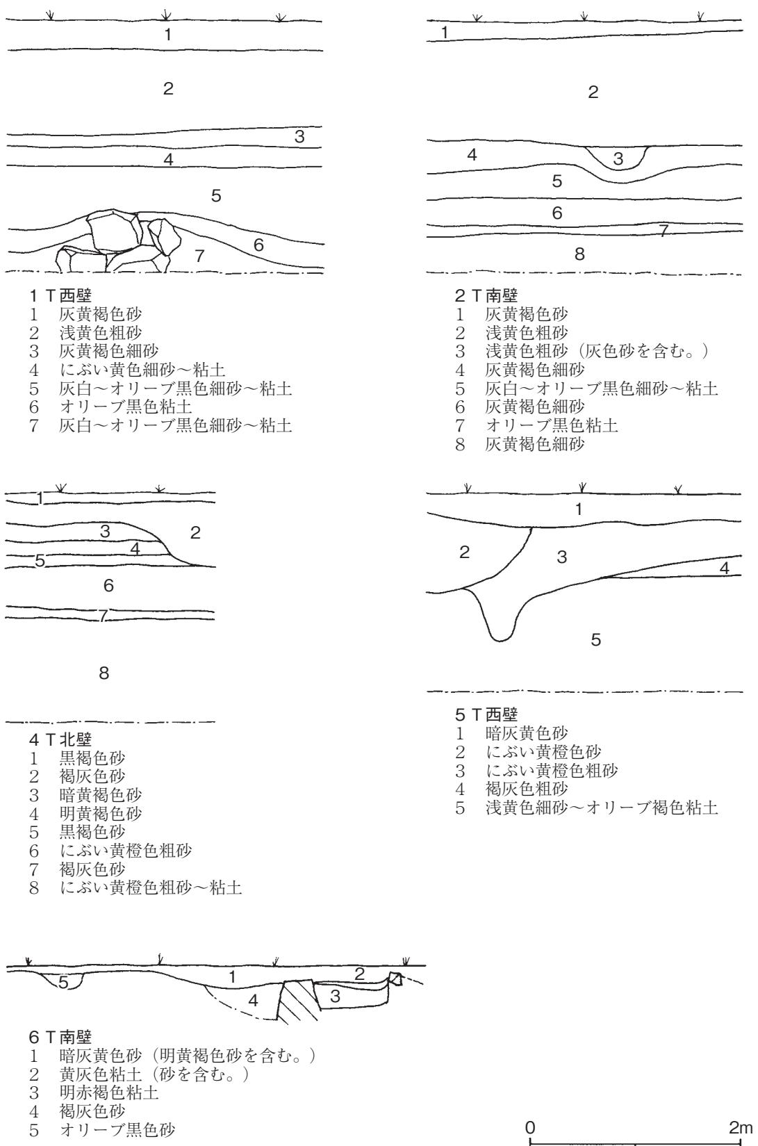
第5図 一般国道2号岩国・大竹道路建設計画地内 1T・2T・4~6T 土層断面図 (1:50)
