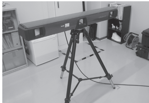
写真 4_ ハンドスキャナー位置計測機器 (T-TRACK CS+)
