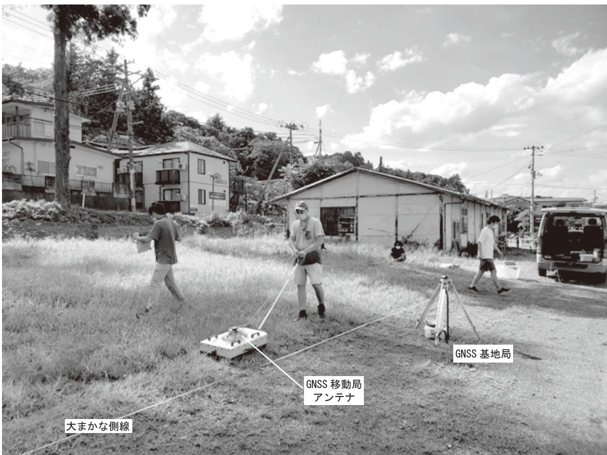
①RTK-GNSS 測位を併用した地中レーダー計測
