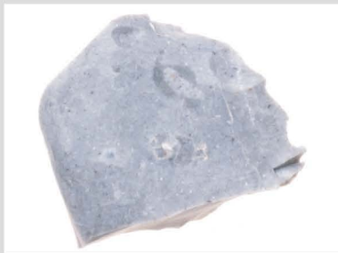
10 玉髓質泥岩原石001 900°C 2h
