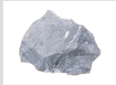
9 玉髓質泥岩原石001 800°C 2h
