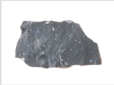
7 玉髓質泥岩原石001 600°C 2h
