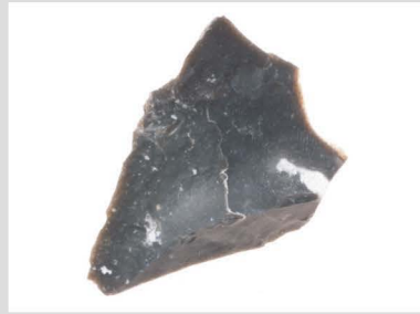
5 玉髓質泥岩原石001 400°C 2h
