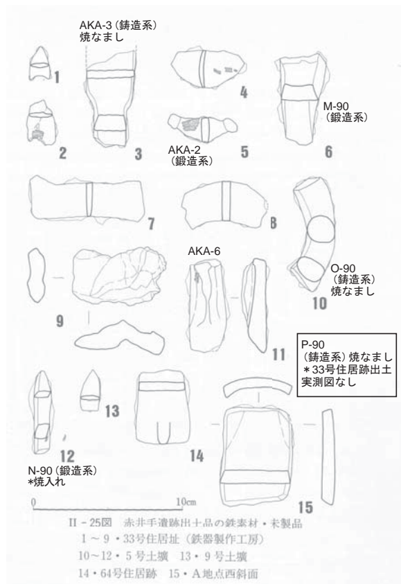
1. 赤井手遺跡出土鉄器・鉄片とその材質 （橋口 1990 II-25 図 大澤 1995 をもとに作成）
