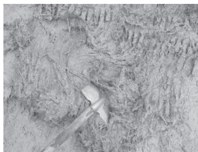
・腐食させた荒壁用土：藁の腐食状態を見る。
