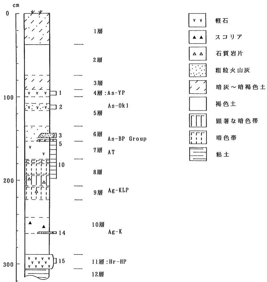
第72図 基本土層断面の土層柱状図
