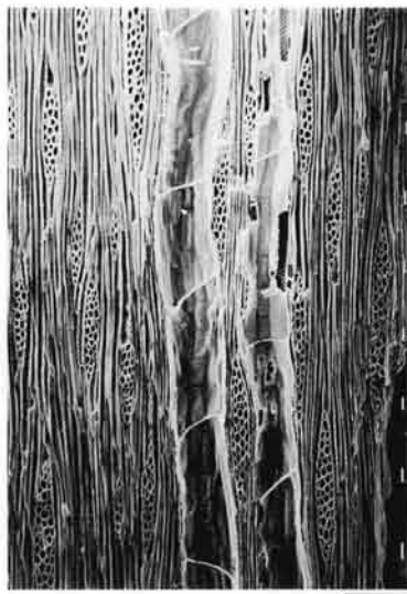
4b イヌエンジュ(接線断面) Niテ-213Y① bar:0.1mm
