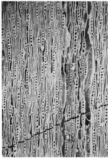
2b クリ(接線断面) Niテ-215Y② bar:0.1mm
