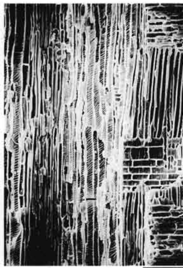
4c イヌエンジュ(放射断面) Niテ-213Y① bar:0.1mm
