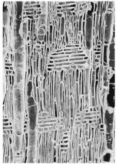
2c クリ(放射断面) Niテ-215Y② bar 0.1mm
