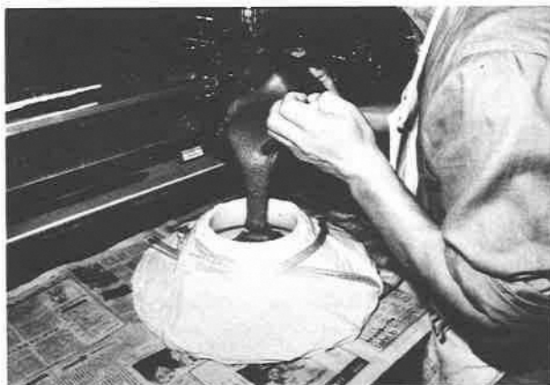
6 凹型へ合成樹脂を流し込む
