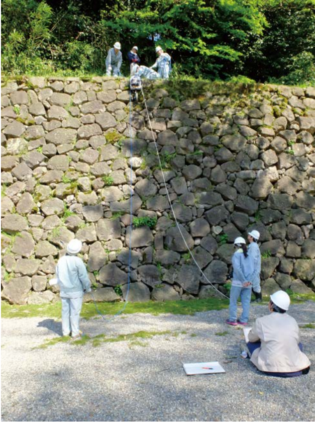
第 82 図 GPR 探査作業風景
