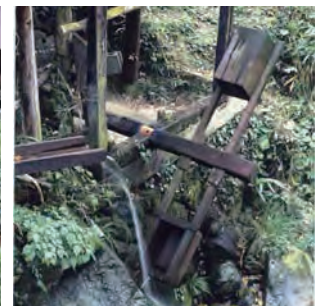
写真7 精米用箱水車
