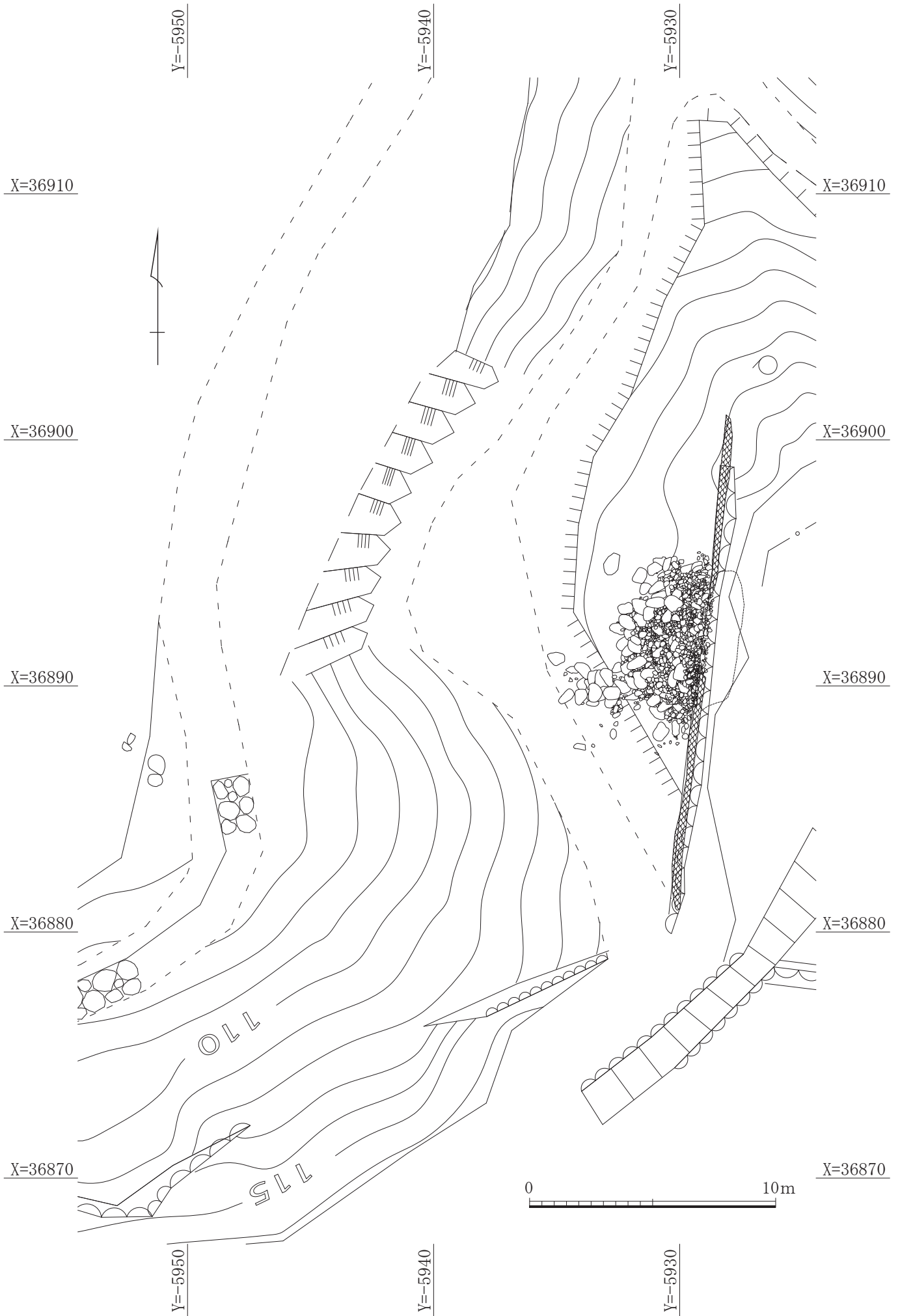
第 23 图 2 工区全体崩落状况平面图 (1/200)
