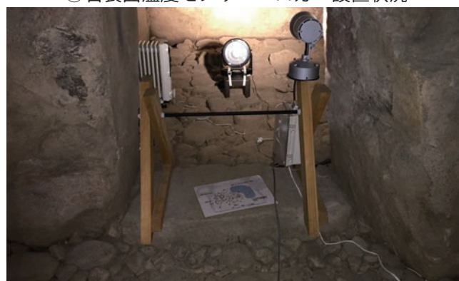
②石表面温度センサー・ロガー設置状況
