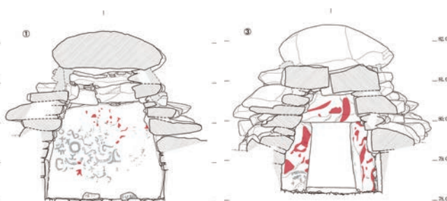
図 3-13 奥壁劣化箇所
