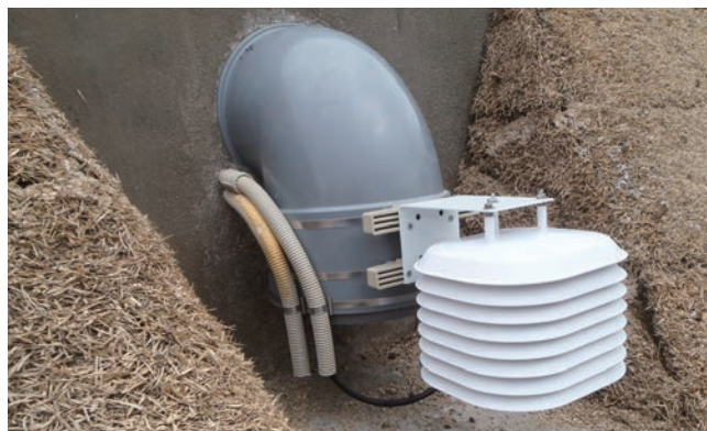
②屋外温湿度センサー設置状況
