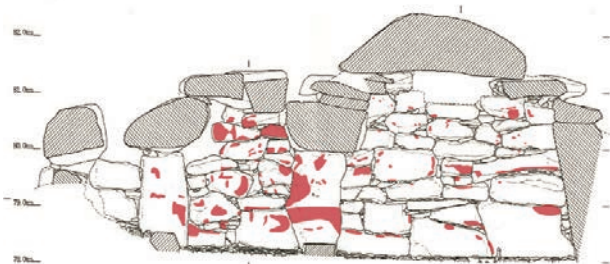
図 3-15 左側壁劣化箇所
