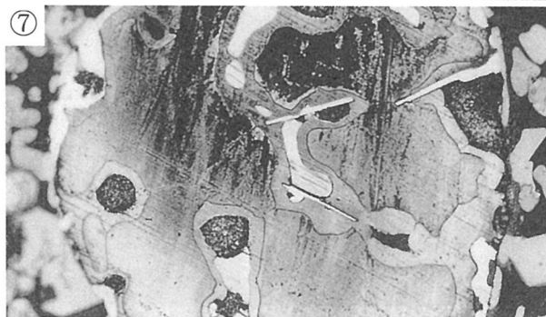
Ⅳ - 2 - 写真3 坩堝 (トリベ) 附着物の顕微鏡組織 (3)
