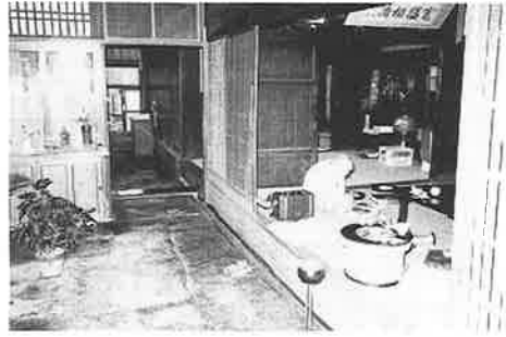
前面道路から裏側へ抜ける土間（通り庭） にそって縦長に各室を並べている （田村正作家）。
