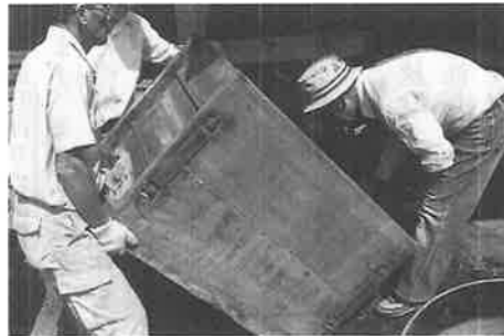
醤油しぼりのフネ 幅—100センチ 奥行—69.5センチ 深さ—70センチ
