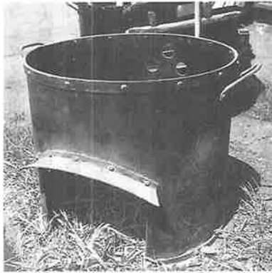
ニガマをかける鉄製のヘツツイ 径—72.5センチ 深さ—61.5センチ
