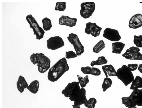
写真3 試料2 (SI03-7層, 透過光) 中央右: 繊維束状軽石型ガラス, 右上(有色鉱物): 斜方輝石.
