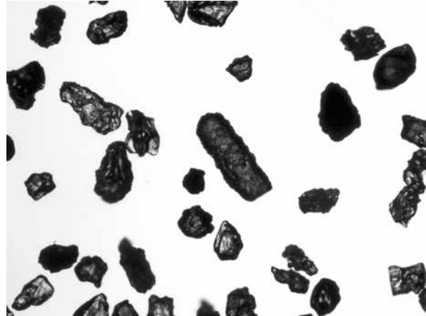
写真1 試料1 (SK20-1層下面, 透過光) 中央・右下: スポンジ状軽石型ガラス, 右: 繊維束状軽石型ガラス, 中央(有色鉱物): 斜方輝石.
