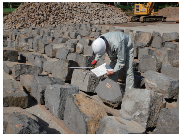
⑤ 築石石材調査 石材の大きさ、加工の特徴、損傷などを調査します。
