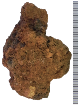
KWK-2 製錬滓(含鉄) 外観写真
