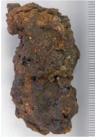
KWK-1 製錬滓(含鉄) 外観写真
