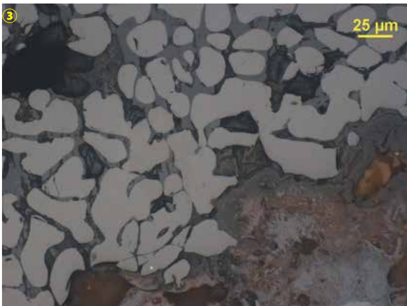
図5 TTS-4 鍛冶滓 顕微鏡組織図
