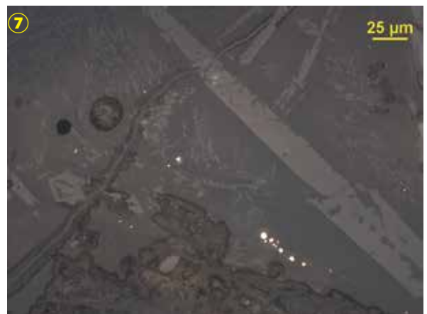
図3 TTS-3 鍛冶滓 顕微鏡組織図
