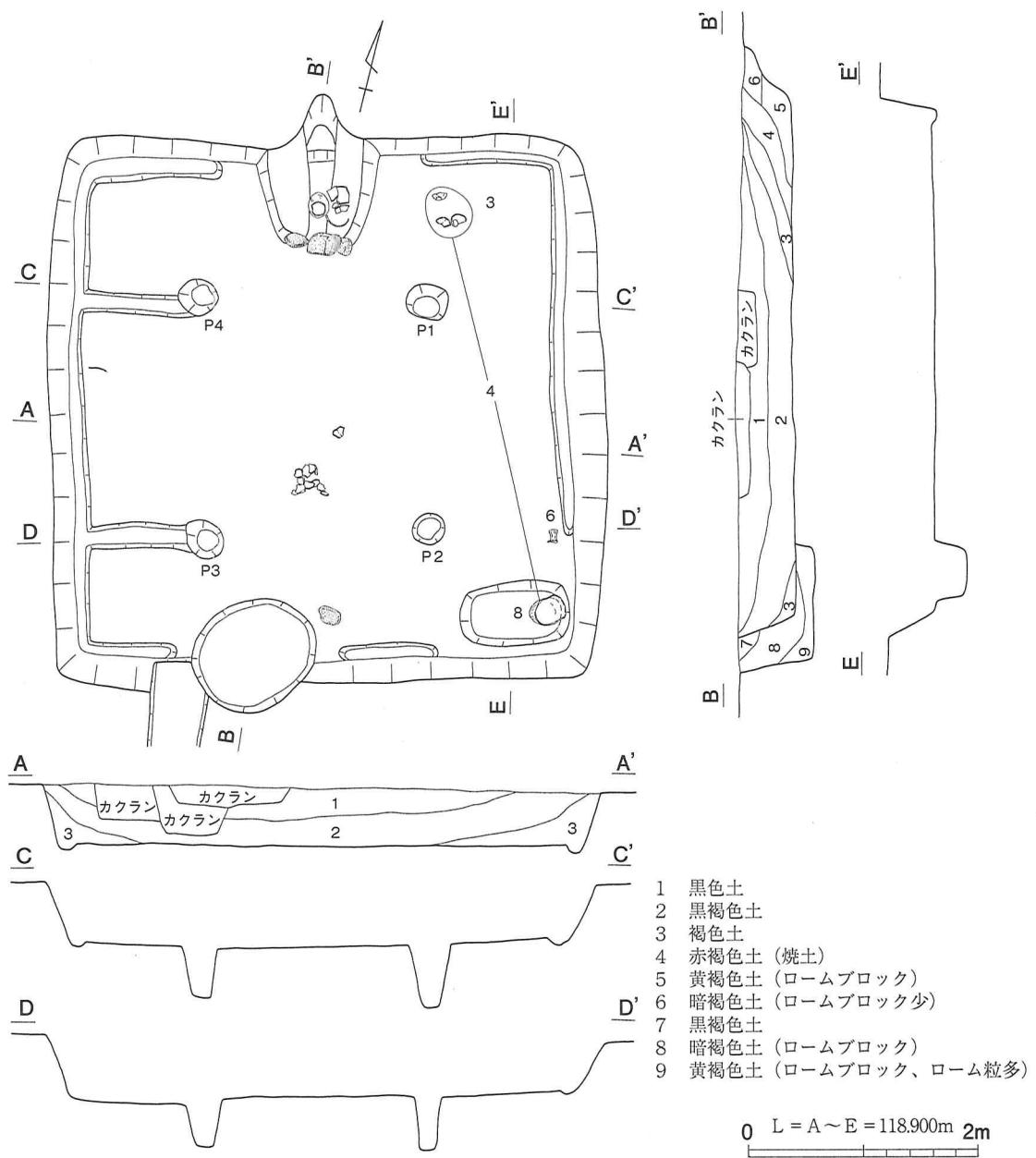
第56図 B区38号住居跡平・断面図
