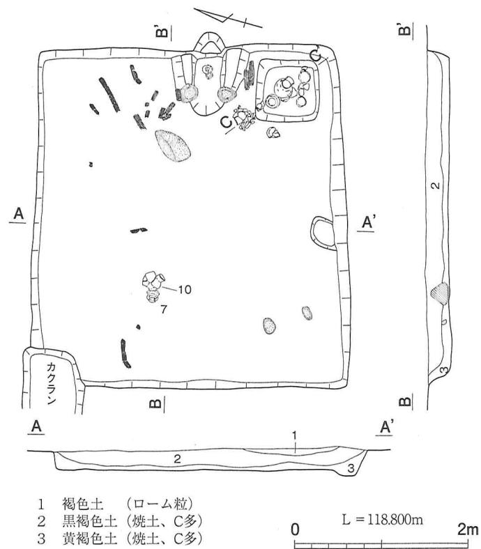
第48図 B区32号住居跡平・断面図
