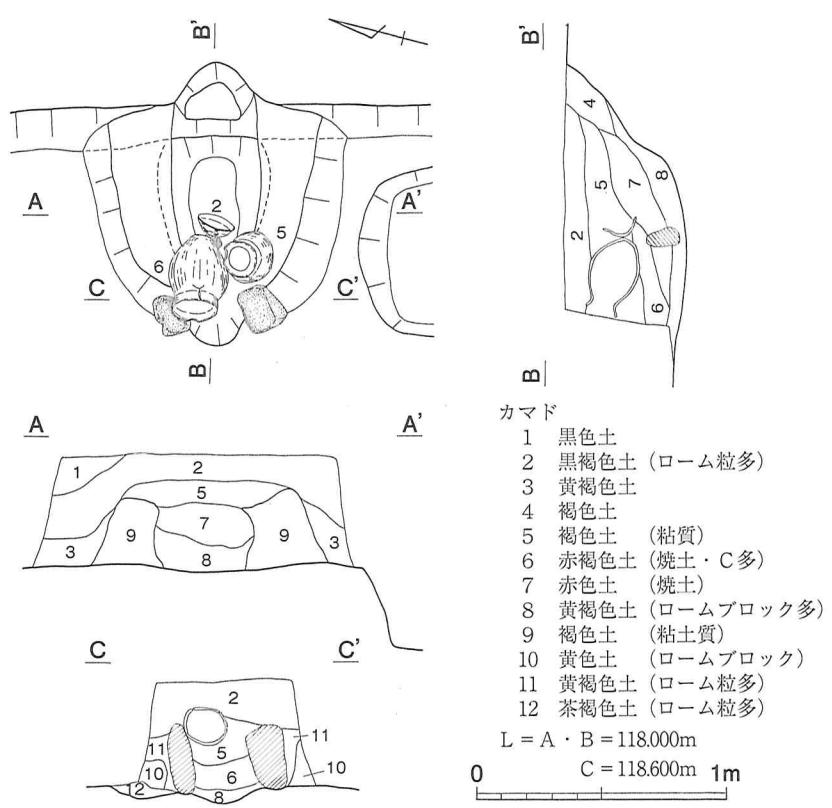
第63図 C区30号住居跡カマド平・断面図
