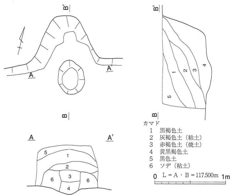
第164図 44号住居跡カマド平・断面図
