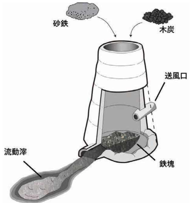
第5図 円筒形自立炉模式図
