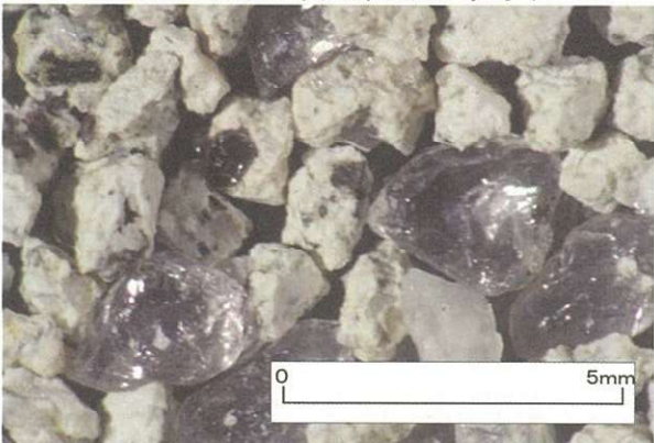
写真8 十勝溶結凝灰岩中の高温型石英
