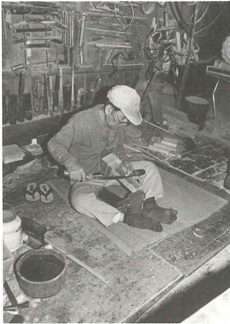
写真23 桶側を鑿で削る（日田市）
