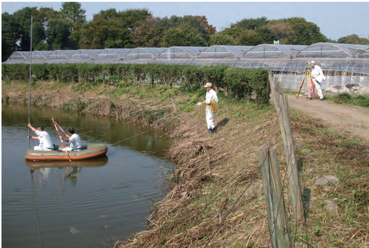
内堀の深度調査(平成20年10月) (3Dレーザー測量では水面下は計測不能なため、手測りによる補足測量)
