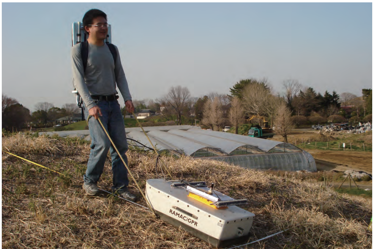
地中レーダー探査実験 (東北大学東北アジア研究センターとの共同研究)
