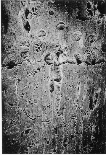
4a ヤマグワ (横断面) SK02 ber:0.5mm
