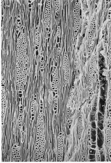
4b ヤマグワ (接線断面) SK02 ber:0.5mm
