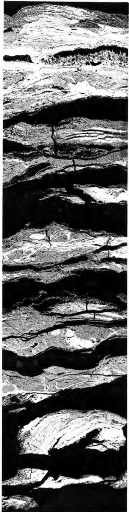
鉄装大刀破片厚み方向の顕微鏡組織
