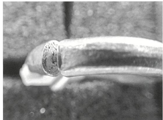
図3 No.59耳環端部の鍛造痕
