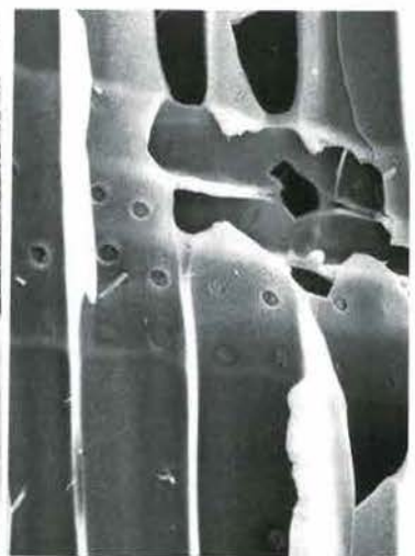
5c ネズコ(放射断面) 破片仮No.5 bar:0.05mm
