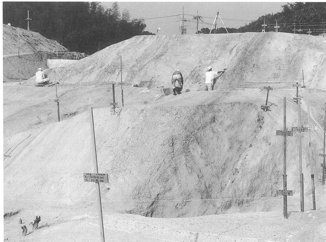
写真11 断層の下盤側における大阪層群の傾斜
