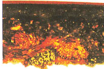
黒色系漆 (VI), 布着せ補強例
