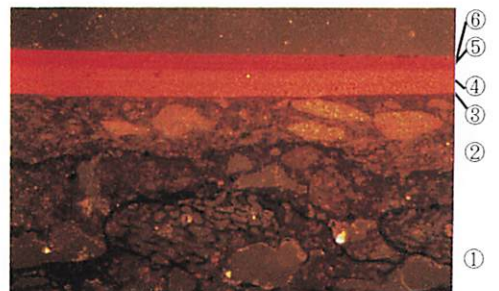
①布着せ補強 ②サビ下地 ③朱漆 ④朱漆 ⑤朱漆 ⑥朱漆 (落射)
