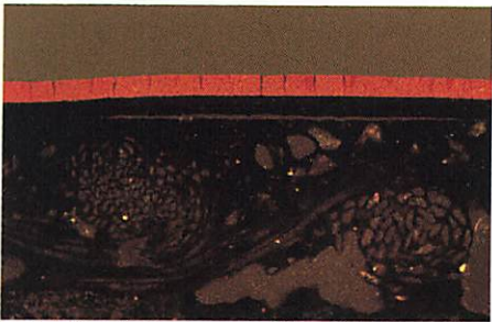
①布着せ補強 ②サビ下地 ③赤褐色系漆 ④朱漆 (落射)
