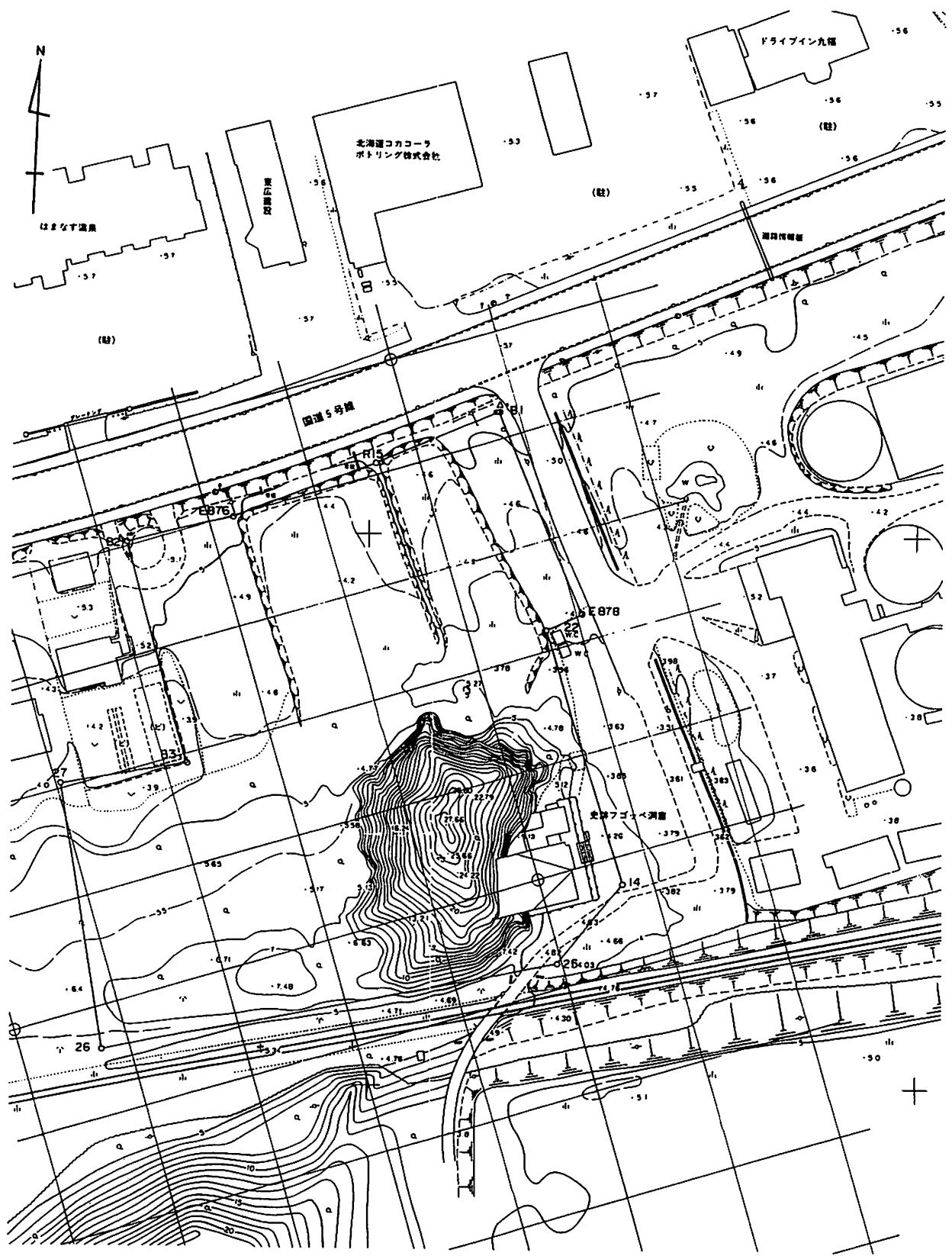
第1図 フゴッペ洞窟周辺の地形 (1/1000) シン技術コンサルタントの測量による 1951年の洞窟測量基点に基き20m方眼を設定し発掘調査を実施
