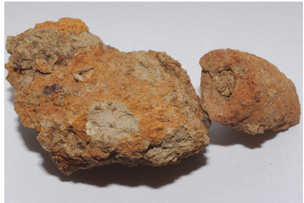
4. 粘土の周囲に凝集した褐鉄鉱
