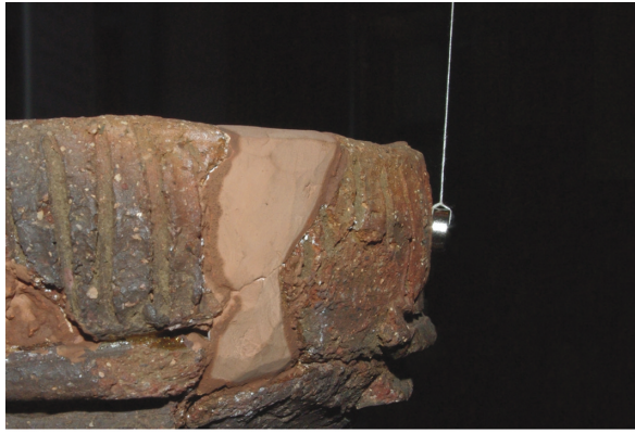
1. 吊した磁石による磁性の確認
