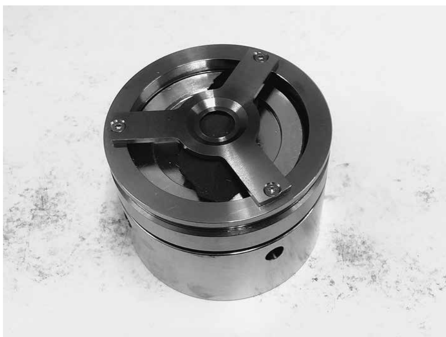
第 12 図 サンプルホルダーへの資料の固定
