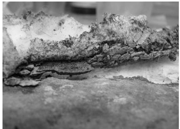
写真22 養生紙（樹脂含む）の除去
