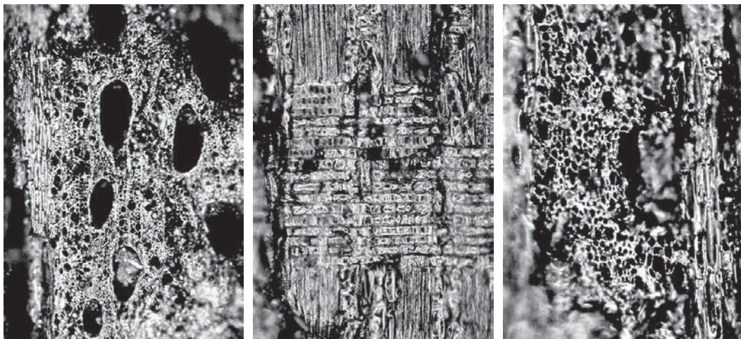
横断面 ————— : 0.4mm 放射断面 ————— : 0.2mm 接線断面 ————— : 0.2mm 6. SA3 1 木製鋤 (部位不明) コナラ属アカガシ亜属
