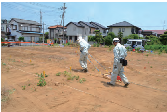
2. GPR探査 調査風景
