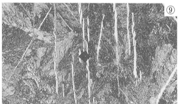
写真3 含鉄腕形鍛冶滓の顕微鏡組織
