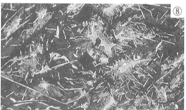
写真11 鉄塊系遺物の顕微鏡組織
