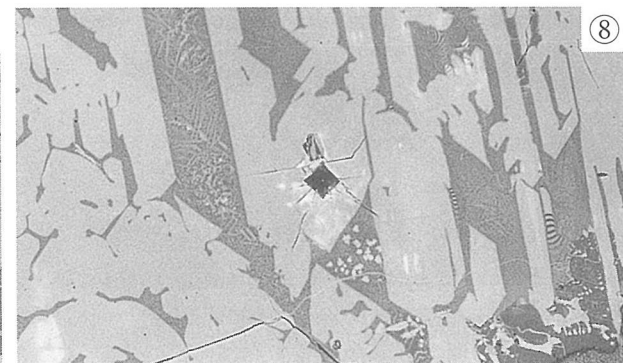
写真8 椀形鍛冶滓の顕微鏡組織
