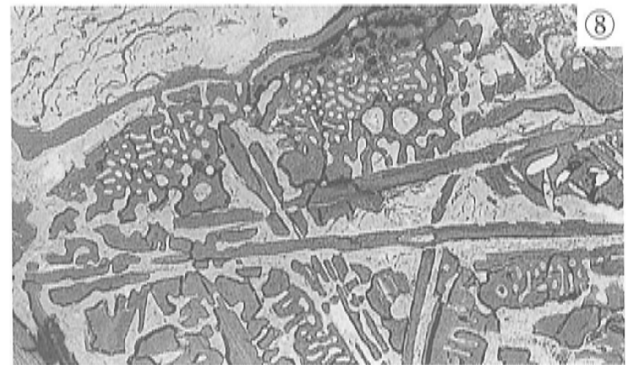
写真14 ガラス質滓・鉄塊系遺物の顕微鏡組織
