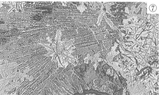
写真15 鉄滓片・鉄塊系遺物の顕微鏡組織
